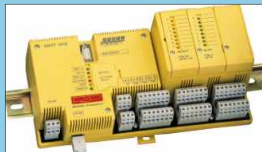
Контроллер Smart I/O
